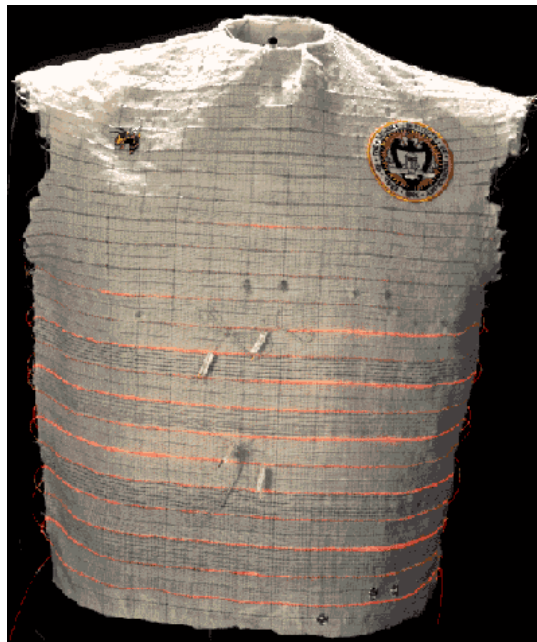
Fig. 2. Prototipul uniformei militare “inteligentă” (dupa SensaTex Inc.)
