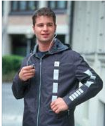
Fig.4. Jacheta “audio” ce permite înregistrarea și redarea fișierelor mp3 (după Infineon Technologies)
